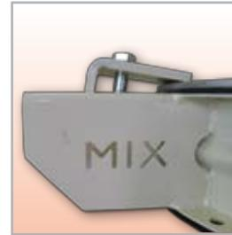
Nella versione **SVQ** vengono fornite in dotazione n°4 staffe di ancoraggio regolabili; ogni fissaggio è garantito da una connessione bullonata completa di rondella a cuneo (quindi la vite non viene deformata e mantiene un carico uniforme nel tempo)
