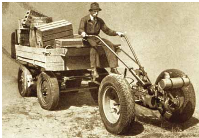
Nel 1948 la tedesca Hofmann presenta il motocoltivatore Universal con motore Fichtel & Sachs di 300 cm 3 e potenza di 6,5 CV. Sono 20 gli accessori di cui può essere dotato, tra cui questo rimorchio a due assi
