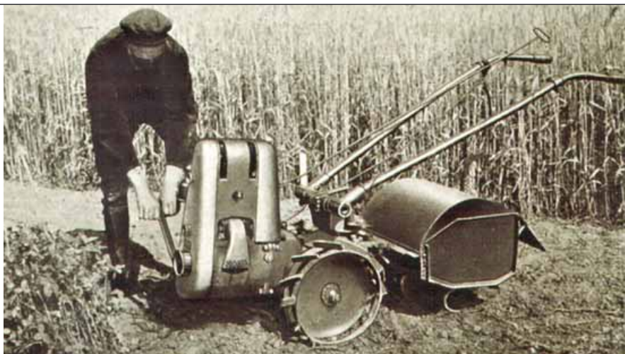
Avviamento a strappo di un motocoltivatore Siemens-Schuckert K 4, 1924 . Monta un motore monocilindrico a 2 tempi da 4,5 CV a 1.500 giri/min
