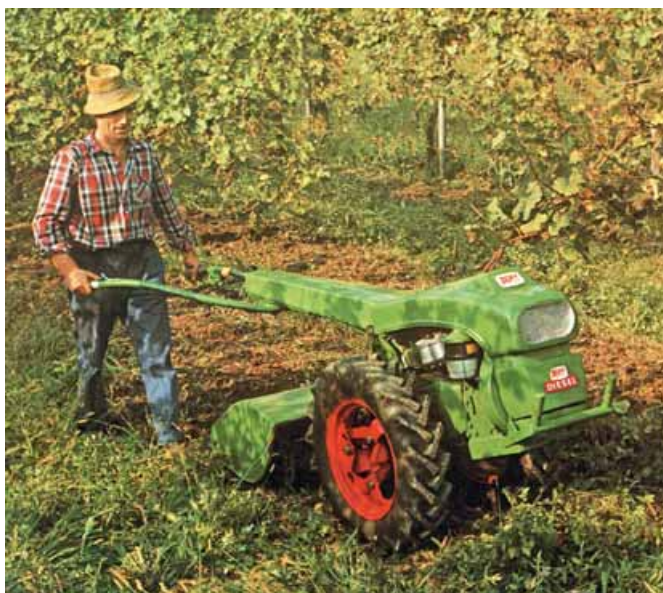
Motocoltivatore Pasquali 900 Fr , con motore diesel Ruggerini da 18 CV (1955 circa). L'assale sterzante con posto guida reversibile lo trasforma in un mini-trattore
