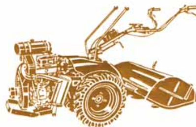
La Moto Guzzi produce, oltre alle due ruote, una serie di motozappatrici e motocoltivatori. Il modello più grande è l' Universal con motore di 500 cm 3 e potenza di 10 CV (1968)
