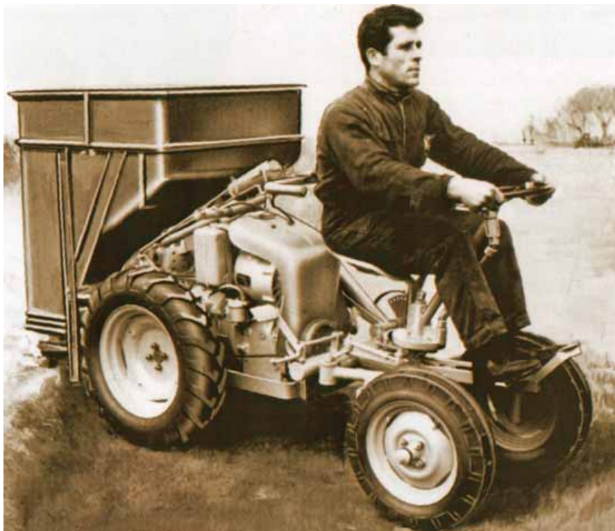
Motocoltivatore Pasquali 900 Fr , con motore diesel Ruggerini da 18 CV (1955 circa). L'assale sterzante con posto guida reversibile lo trasforma in un mini-trattore
