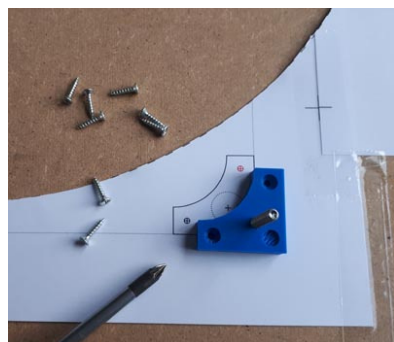
Figuur 8: Montageblokjes monteren op sjabloon. Zet de schroef alleen in het rood gemarkeerde gat!
